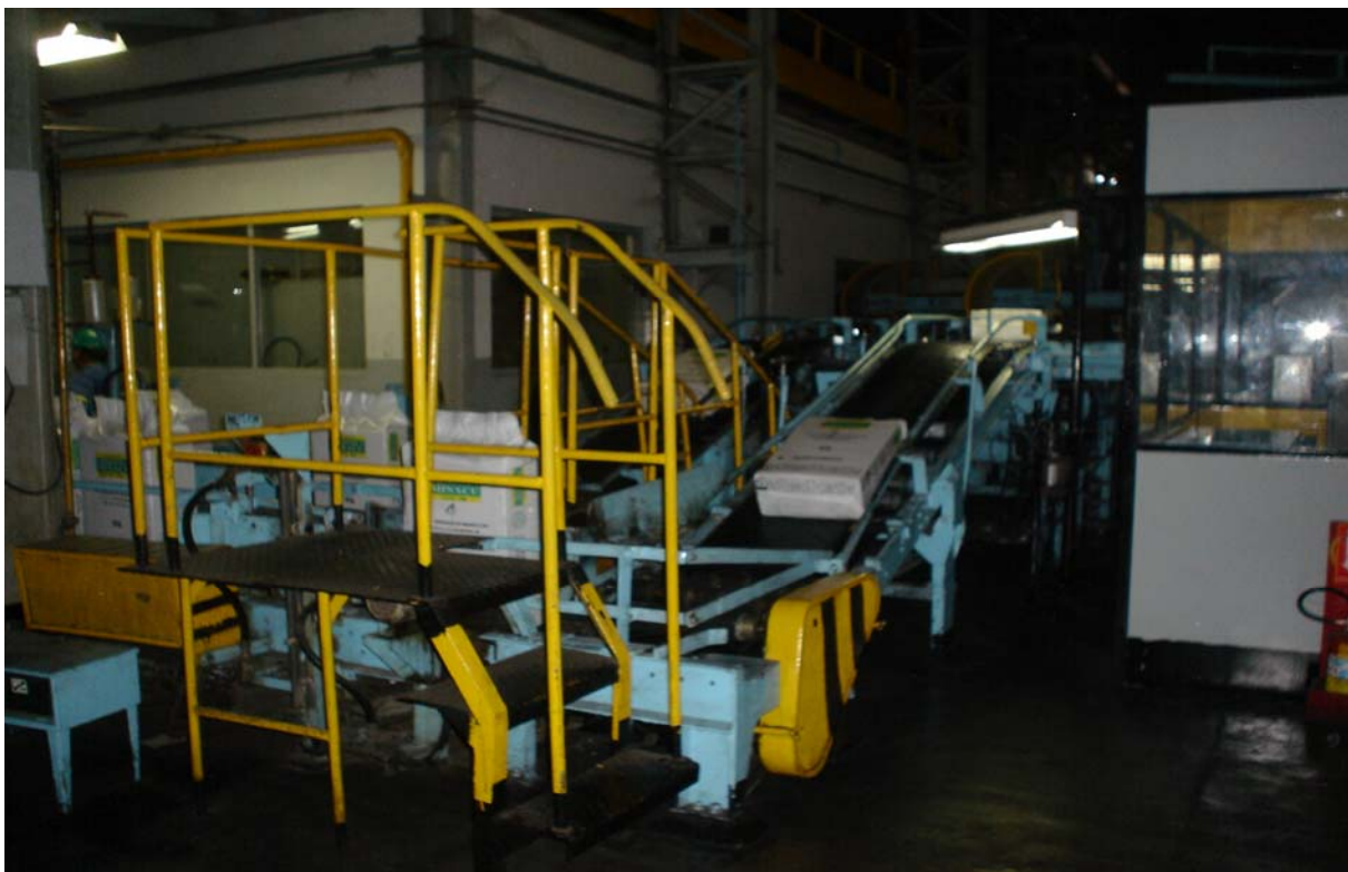
Foto nº 13 - Após embalado, o mineral segue por uma esteira para outro Setor, onde será preparado para o empilhamento e posterior transporte e exportação.
