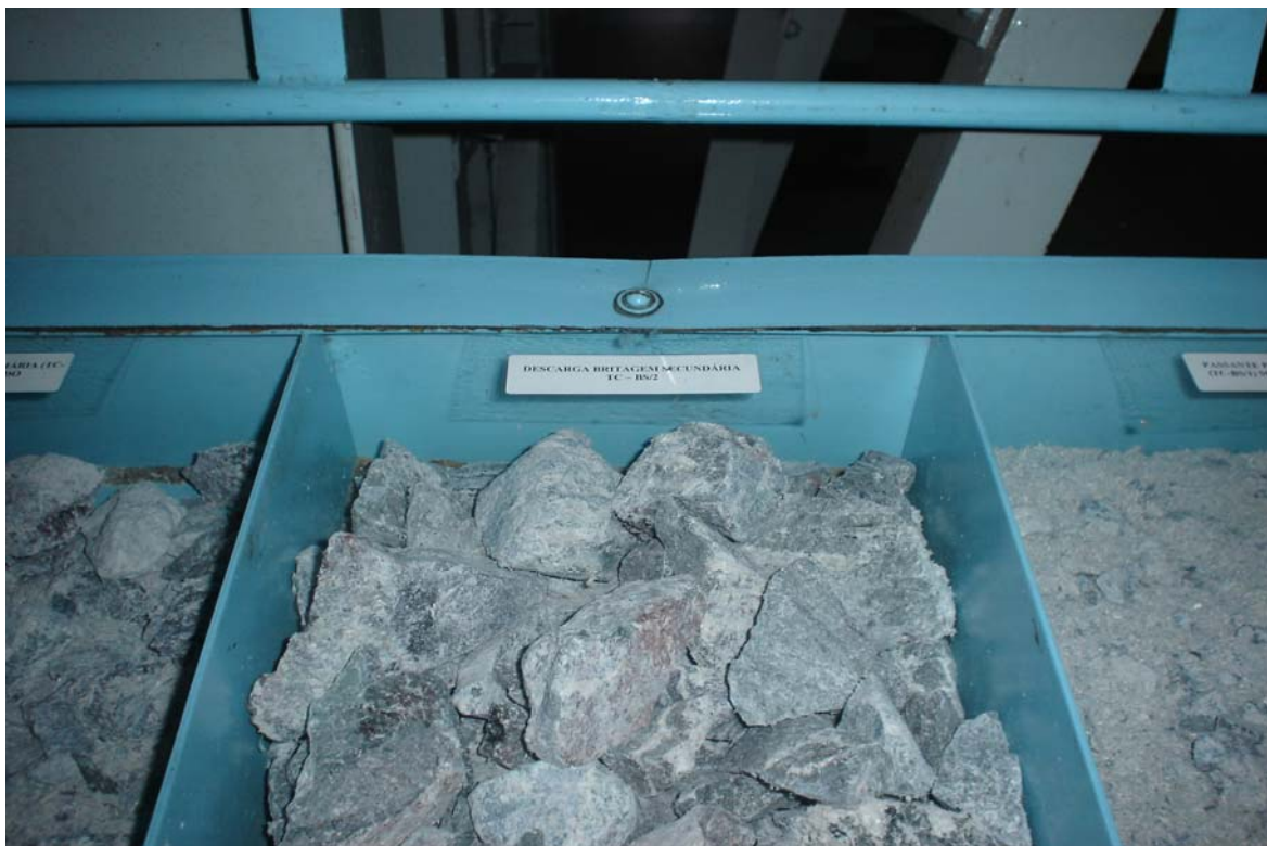
Foto nº 9 - Descarga da britagem secundária
