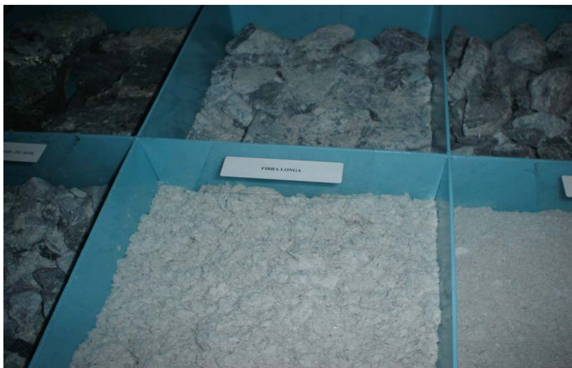
Foto nº 11 - Amianto fibra longa
