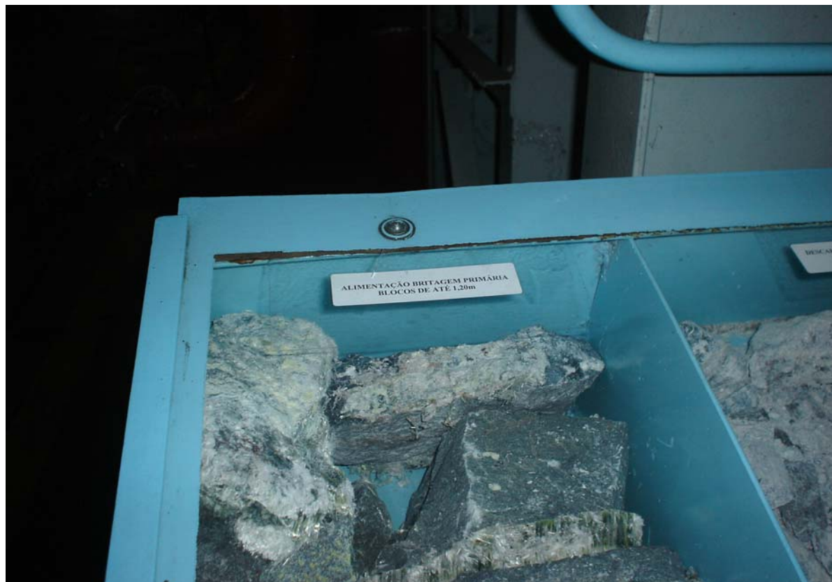
Foto nº 8 - Alimentação britagem primária – blocos de até 1,20 m
