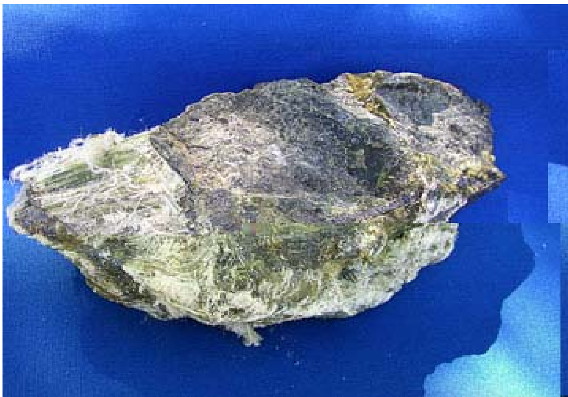
Foto nº 3 - Rocha do amianto, com destaque nítido das fibras
