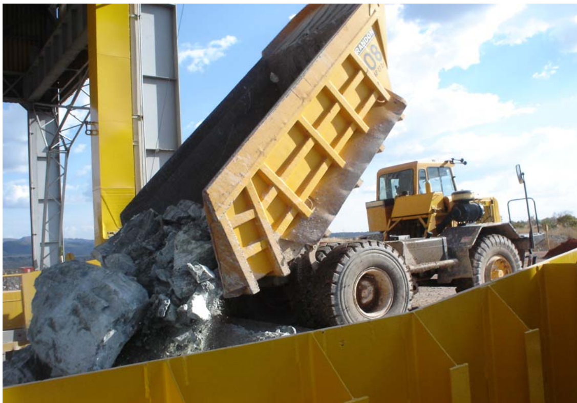
Foto nº 5 - Descarregamento das rochas de amianto, para a britagem primária.
