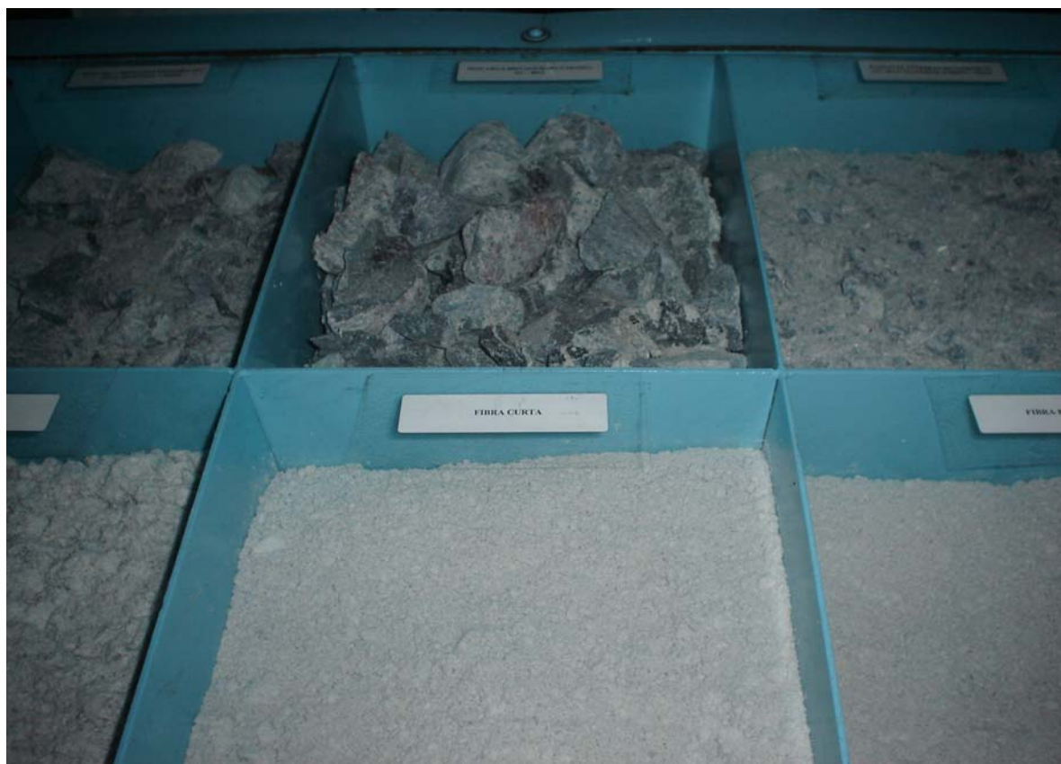
Foto nº 10 - Amianto fibra curta
